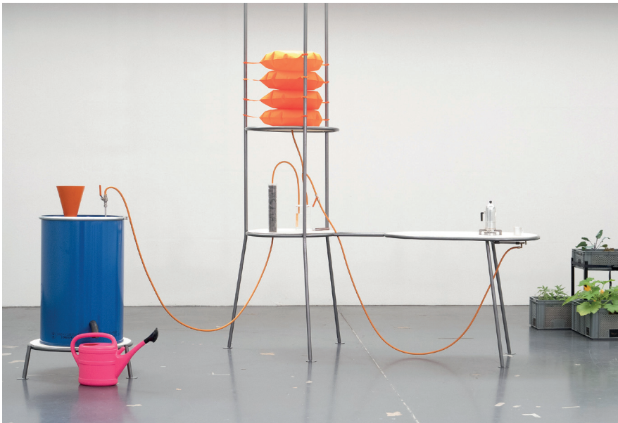
Karl Schinkel & Björn Naumann, C.O.W. – circular organic waste. Eine Kochstelle nutzt Gas, das durch die bakterielle Zersetzung von Bioabfällen erzeugt wird (GiebichenStein Designpreis Beste Idee/Bestes Konzept) /A cooktop uses gas produced by the bacterial decomposition of biowaste (GiebichenStein Design Award Best Idea/Best Concept).
